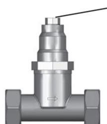
Wert durch Ein- bzw. Herausschrauben der Spindel „X“ mit Gabelschlüssel (SW 11 mm) einstellen.
